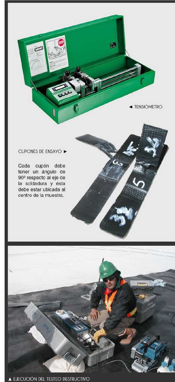
▲ PRUEBA A ESFUERZOS DE CORTE Y ADHERENCIA: LOS CUPONES SON TESTEADOS EN UN TENSIÓMETRO PREVIAMENTE CALIBRADO, CUYA VELOCIDAD DE SEPARACIÓN DE LA MANDÍBULA ES DE 2 PULGADAS POR MINUTO.
