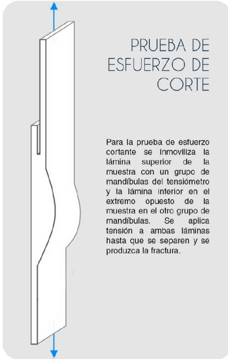
▲ PRUEBA A ESFUERZOS DE CORTE Y ADHERENCIA: LOS CUPONES SON TESTEADOS EN UN TENSIÓMETRO PREVIAMENTE CALIBRADO, CUYA VELOCIDAD DE SEPARACIÓN DE LA MANDÍBULA ES DE 2 PULGADAS POR MINUTO.
